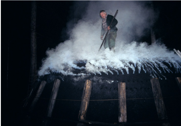
Alle paar Stunden ernährt der Köhler den Meiler durch Einwerfen glühender Kohle ins «Füllihus» © Paul Duss, Romoos
